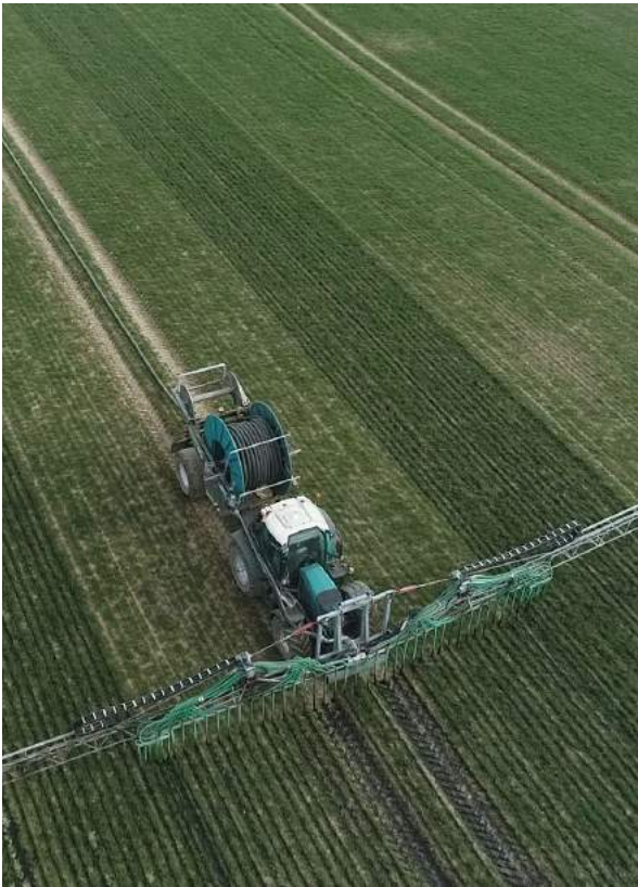
Épandage de digestat liquide sans tonne avec système Duaferti ® (Crédit : Watts-New)
