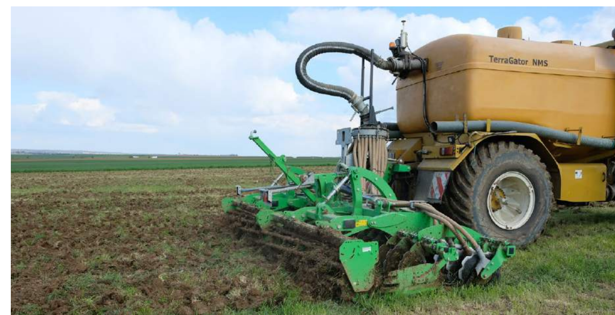
Épandage de lisier avec automoteur et enfouisseur à disques
