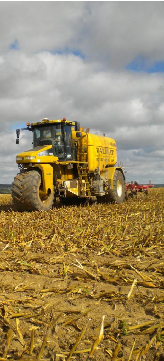
Épandage de digestat liquide avec automoteur et enfouisseur (Crédit : AgroParisTech)
