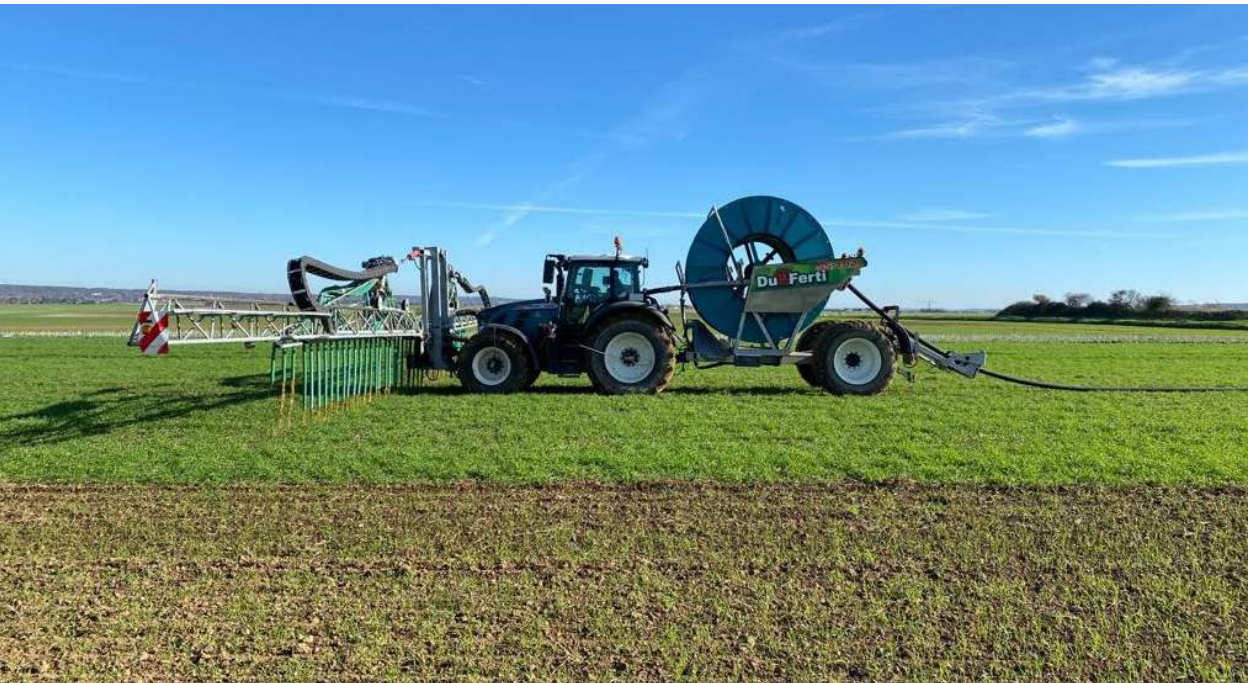
Épandage de digestat liquide sans tonne avec système Duaferti®
